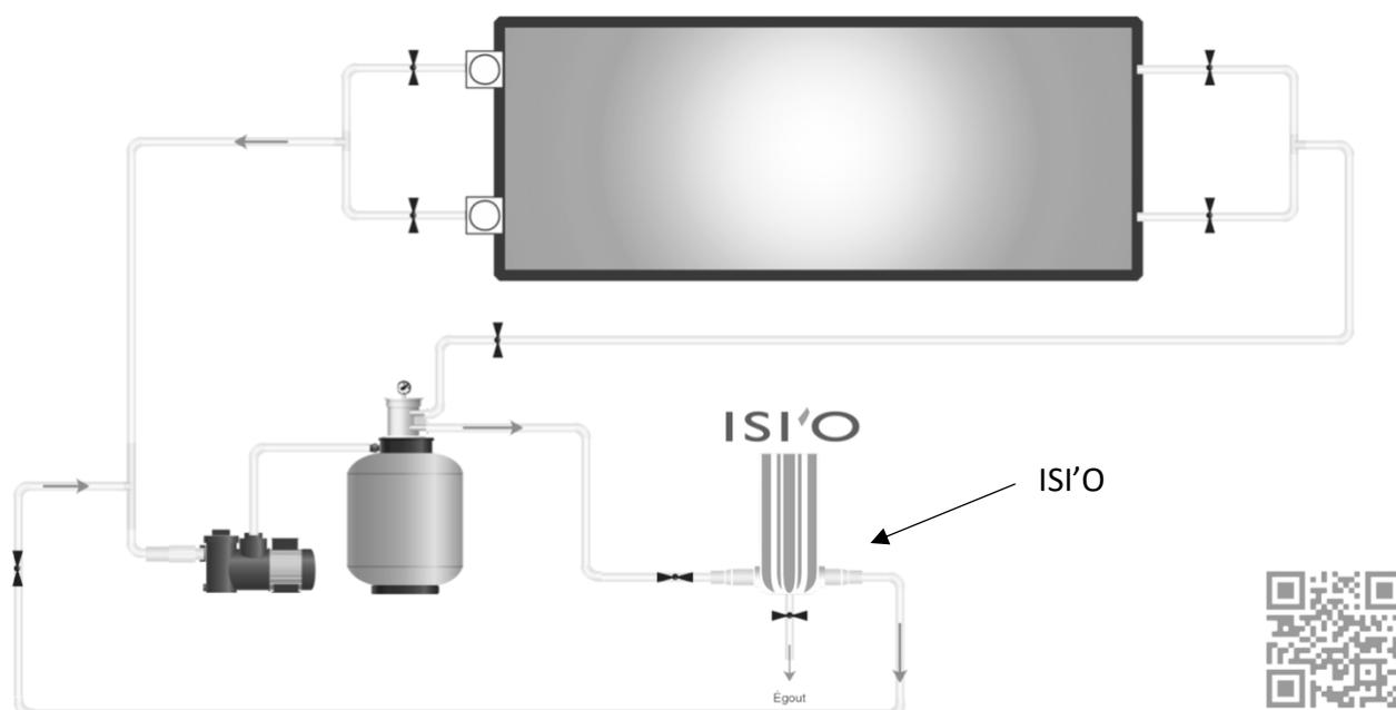
Le filtre ISI'O s'installe en boucle fermée sur le circuit de l'égout du groupe de filtration. En filtrant les eaux de lavage, il évite le rejet de ces eaux à l'égout.
