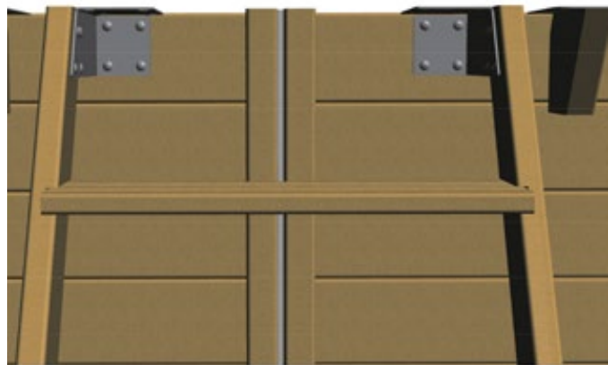
Figure 17 – Fixation de l'escalier extérieur sur le bassin
