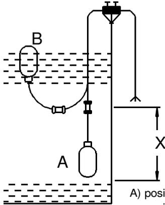
X= altura variable del contrapeso para regulación del punto superior de funcionamiento
